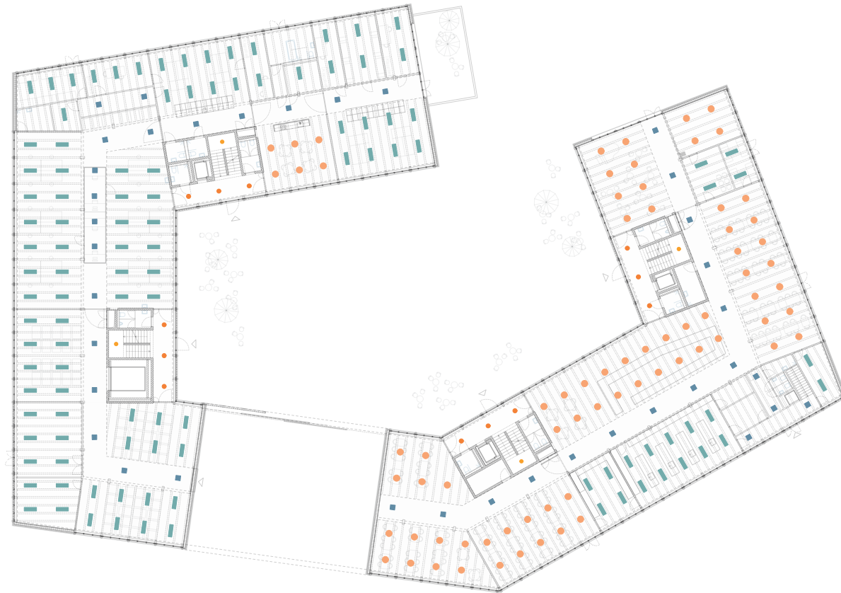
Lichtkonzept für das Erdgeschoss der neuen «Rhyboot»-Werkstätten
